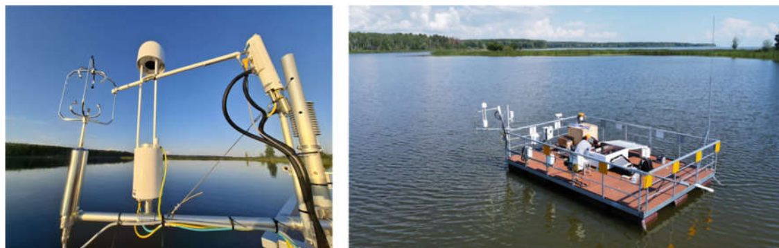
Рис. 10.3. Плавающая платформа с оборудованием для оценки потоков парниковых газов методом турбулентных пульсаций ( https://kpfu.ru/ecology/karbon-povolzhe )
